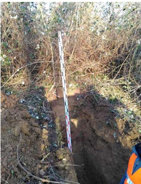
Abbildung 3: Baggerschurf im Abdeckboden mit Messlatte
