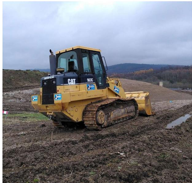
Abbildung 2: Raupe zur Profilierung von Erdmaterial
