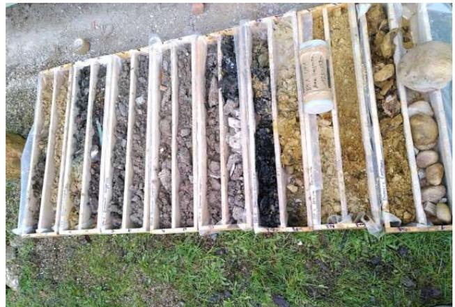
Abbildung 3: Schichtweise Aufnahme des ausgebaggerten Bohrgutes
